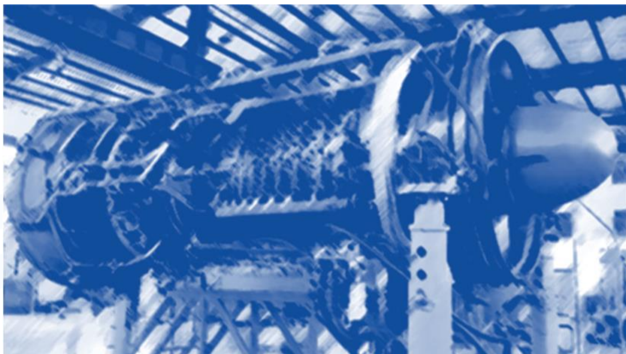
Газовый генератор 30 МВт
